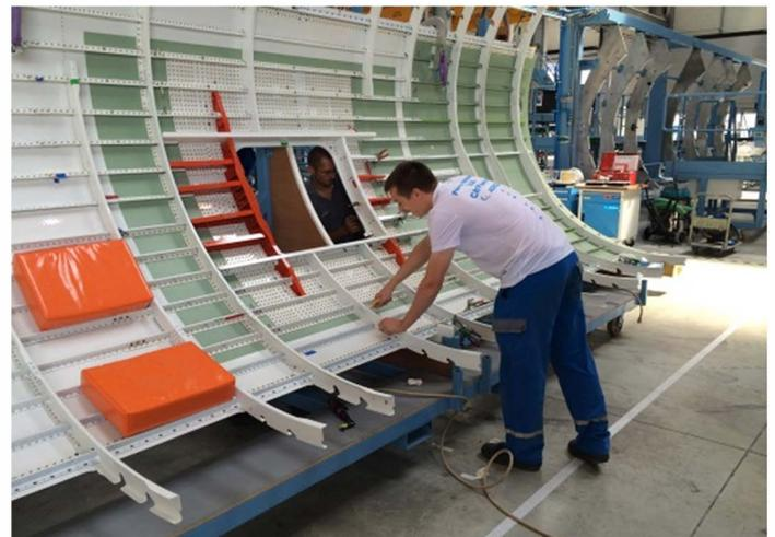
Fuselage équipé et testé
