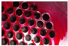
Contrôle ressuage des soudures orbitales
